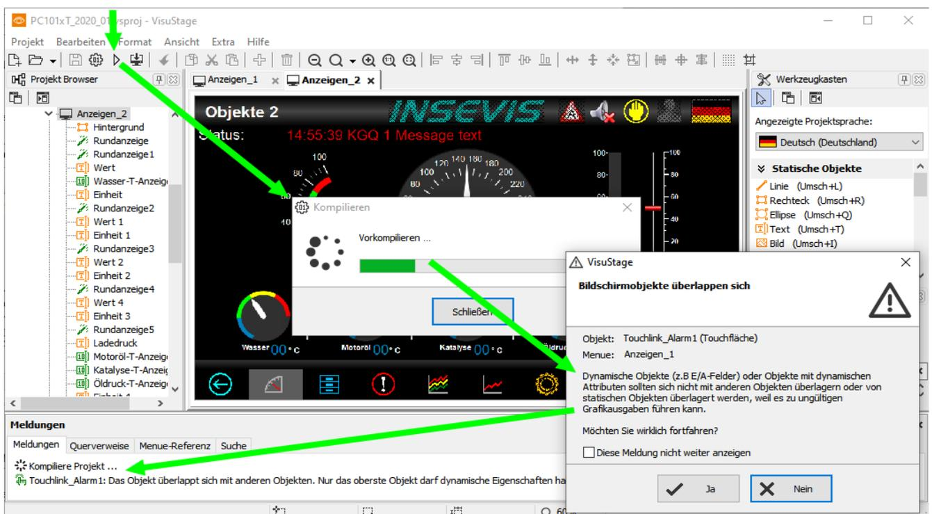
Wenn kein Fehler mehr vorhanden ist, wird der Compiler das \*.bin-File erzeugen und es erfolgt ein automatischer Start des integrierten Simulationsprogramms **SimuStage** und der Simulation der Visualisierung.
