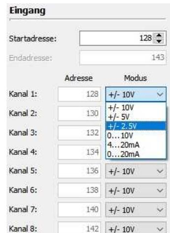
Bild oben: Konfigurationsblock Start-/Endadressen der Ein-/Ausgänge des AI8 (in Wörtern) in der ConfigStage
